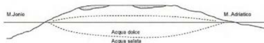
Fig.1 - Sezione idrogeologica semplificata dell'acquifero salentino, direzione E-O.
